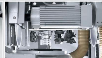
Sägeaggregat zum Ablängen in der Maschine
