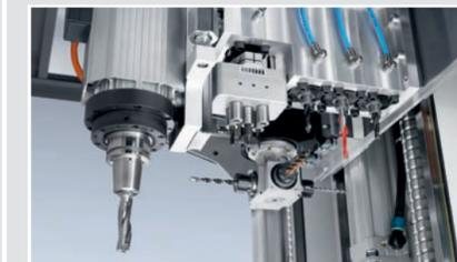
Kombination Mehrspindelbohrkopf horizontal/vertikal mit vertikalem Fräser
